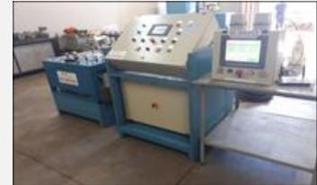
Devido a sua interface de comando com sensores de controle e dispositivos de segurança, garantem a elevação com agilidade e confiança, de forma nivelada e paralela, monitorando em tempo real os dados de pressão e deslocamento individual de cada cilindro, que podem ser vistos em um único monitor.
